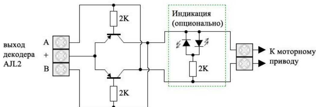
У моторного привода как правило есть 3 провода управления, подключенных к двигателю через диоды и коммутирующие контакты, один из них - общий и 2 другие для выбора направления, для подключения к согласующей схеме необходимо замкнуть 2 провода привода, предназначенные для выбора направления и подсоединить их к одному из выходов согласующей схемы, ко второму выходу согласующей схемы подключите общий провод привода.
